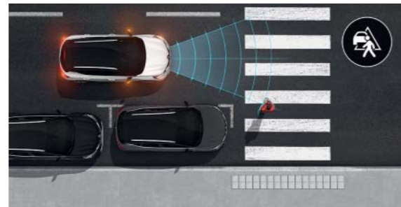
active emergency braking system met voetganger- en fietserdetectie Detecteert fietsers en voetgangers op dezelfde rijstrook of komend vanaf de zijkant en stopt het voertuig bij gevaar. Reizen in de stad is nog nooit zo veilig geweest, dag en nacht.
