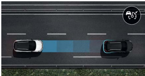
adaptive cruise control Dit systeem waarborgt een veilige afstand tot de voorligger. De auto verhoogt of verlaagt autonoom de snelheid om de ingestelde veilige volgafstand aan te houden.
