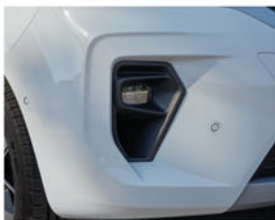
LED-mistlampen voor met bochtverlichtingstechnologie [1]
